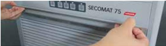
3. Luftfilter mit einer Bürste entstauben und wieder einsetzen.
